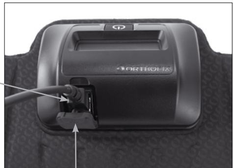
Cubierta del puerto de carga
