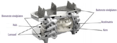
Afbeelding 1: Dwarsdoorsnedeweergave van de M6-C kunstmatige cervicale discus
